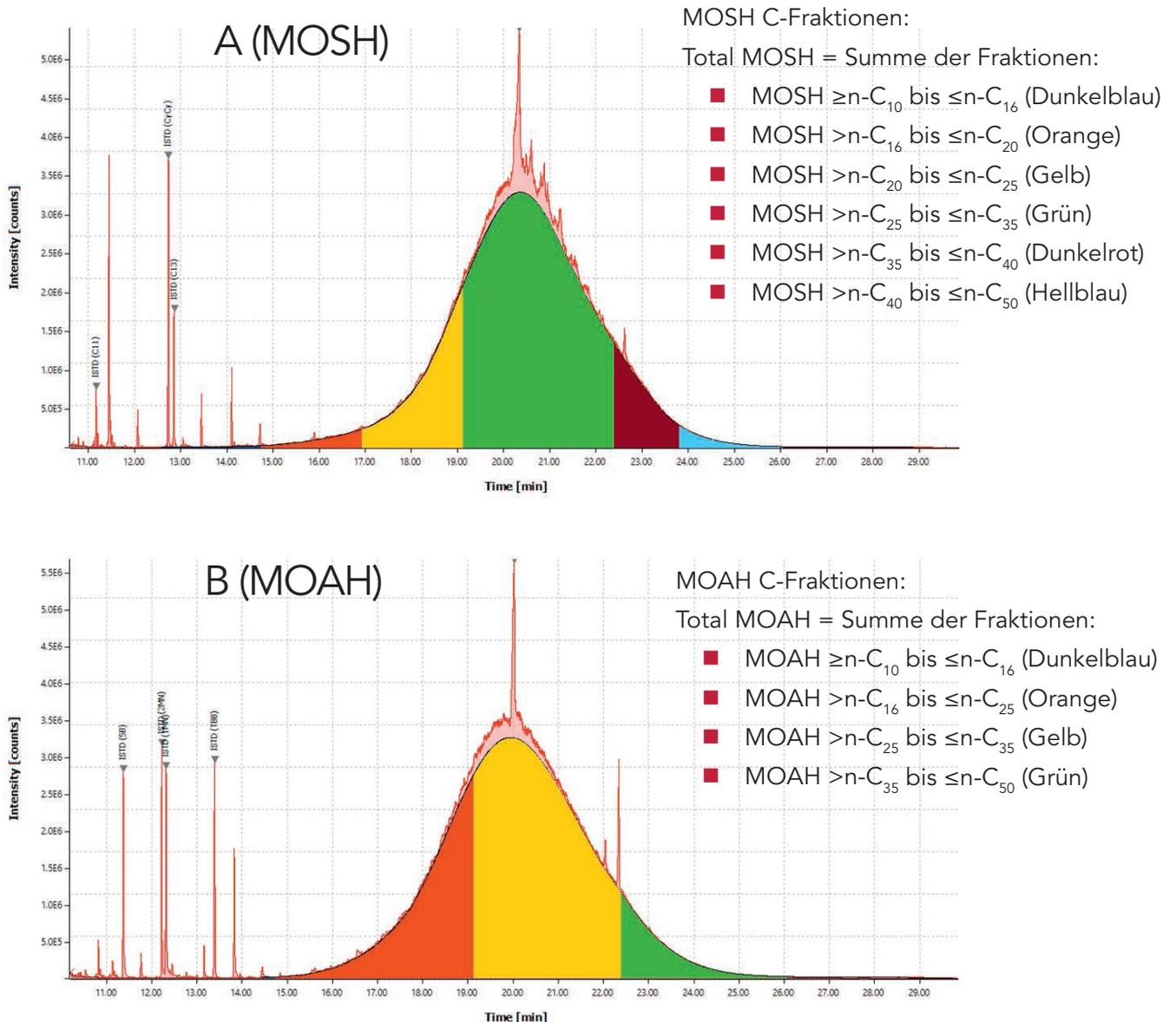
Nicht-getrennte komplexe Mischungen (UCM) von MOSH- (A) und MOAH-Fractionen (B), die aus einem essbaren Öl extrahiert wurden, integriert mit der GERSTEL MOSH/MOAH Data Analysis Software. Die farbigen Peak-(Signal-)Flächen stellen einzelne c-Fractionen dar (siehe Tabellen). Die Gesamt mengen errechnen sich als Summe aller C-Fractionen von  $n-C_{10}$  bis  $n-C_{50}$ .
