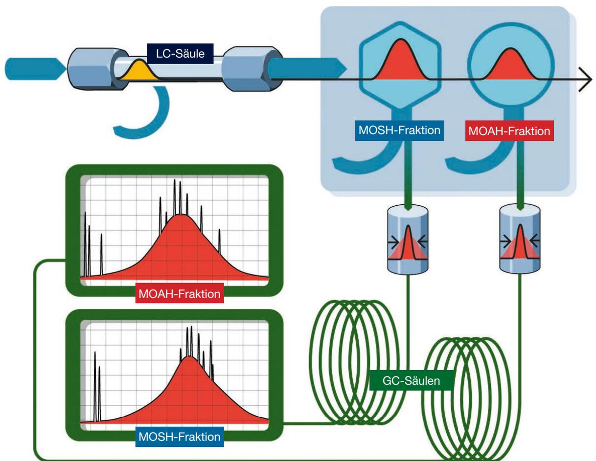
Wie in der DIN EN 16995:2017-08 beschrieben, unterliegen leichtflüchtige Komponenten einem solvent trapping, während schwerflüchtige Komponenten eine Verbreiterung im Einlass erfahren. Hier erfolgt die Refokussierung mittels retention gap. Das zweikanalige GC-FID-System ermöglicht den simultanen GC-Lauf beider Fractionen innerhalb von 30 Minuten.
